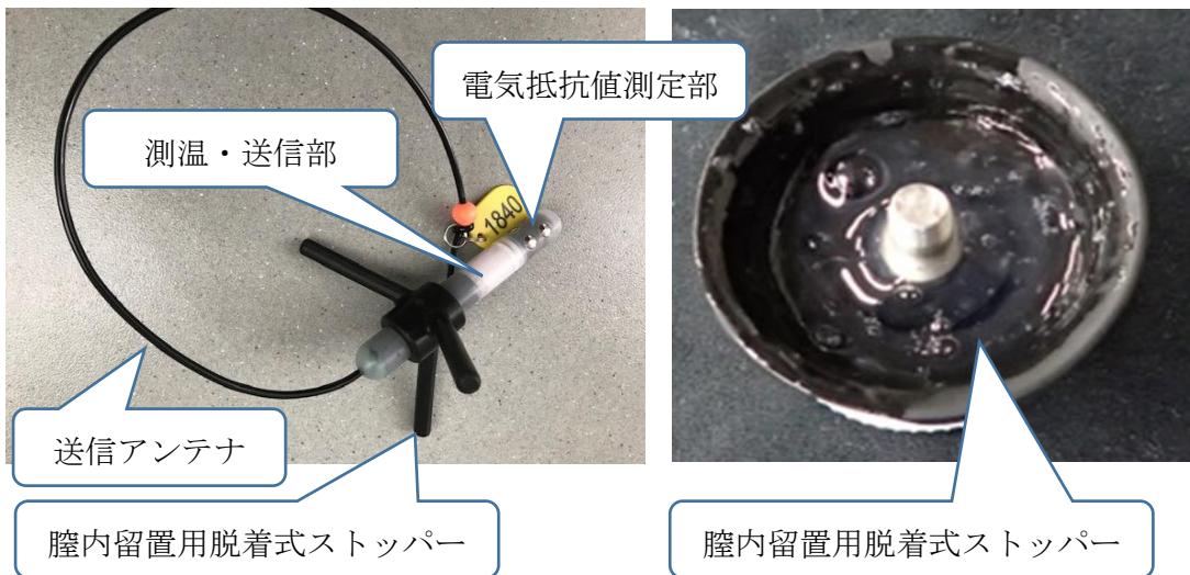
図 5. センサ形状とセンサー挿入時における侵襲性の評価
